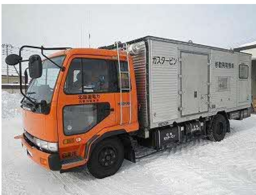
▲ ガスタービン高圧移動発電機車
