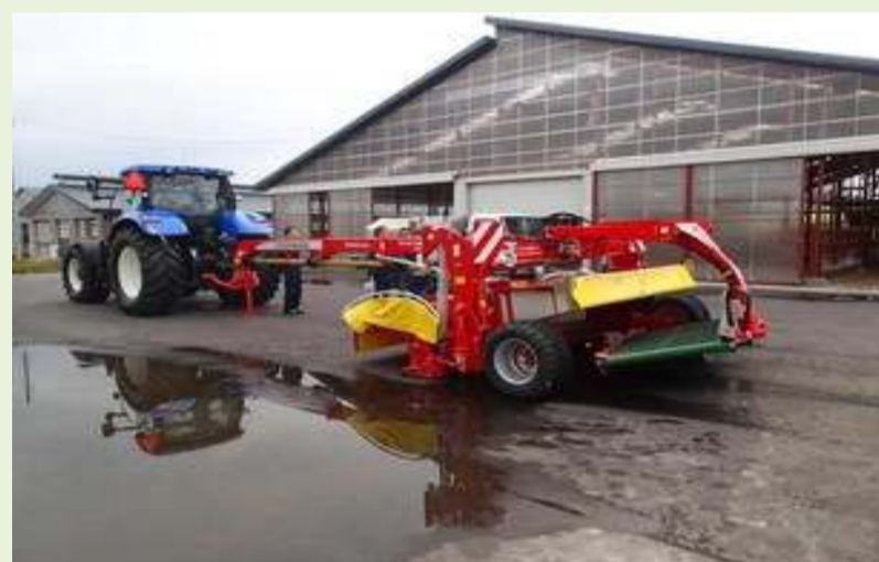
④最後部の緑色の台から、刈り取った草を拡散させて、素早く天日に当てて乾燥を促進します。短時間で乾燥させれば、その後の攪拌作業の回数を少なくすることができます。
