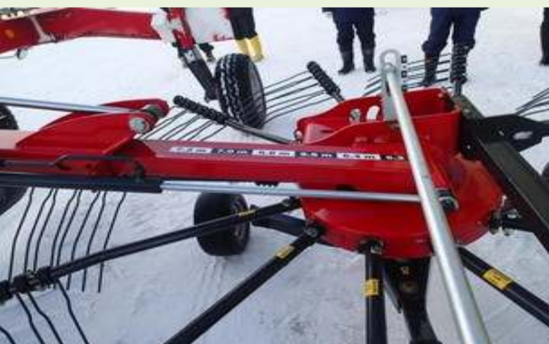
⑦ローターを上から見た写真。フォークの先端のように見える「ホイール」で効率よく草をかき集めていきます。このヘイレーキはオランダのビコン社製です。
