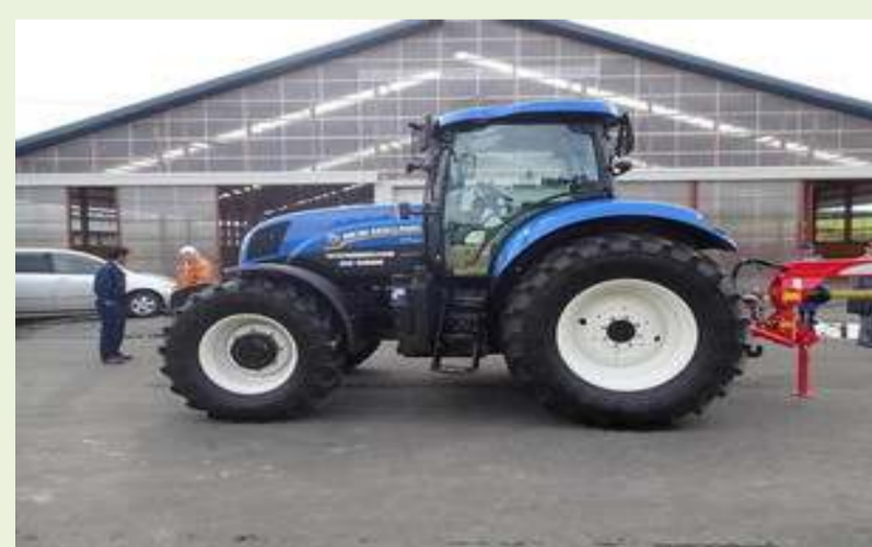
⑧四輪の乗用トラクターです。これでモアコンディショナーやヘイレーキをけん引するとともに、機械を駆動する動力源ともなります。オランダのニューホランド社製です。
