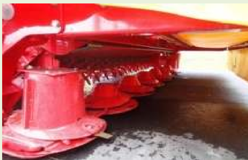
②機械下部前方に取り付けられている刈り取り刃。倒伏した草や背の高い密集した草でもきれいに刈り取ります。刈り取った草は後方に送られます。
