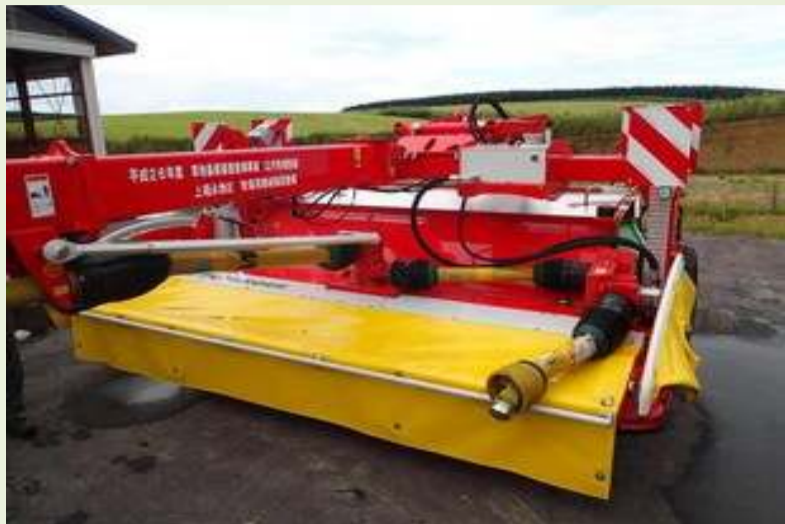
①モアコンディショナーという機械です。モア(刈り取り部)とコンディショナー(圧砕部)から成り立っています。オーストリアのポッティンガー社製です。
