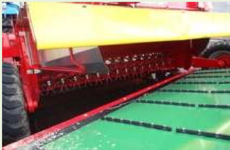
③②で刈り取られた草を圧砕する後部。中央部分にV字型の棘のようなものが見えます。流れてきた牧草をここで均一な配列と本数にまとめる役割を果たします。
