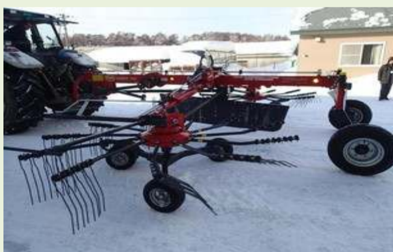
⑥牧草地ではローターと呼ばれる装備を横に上げた状態で動きます。3本のタイヤに支えられているローターを横回転させて集草します。
