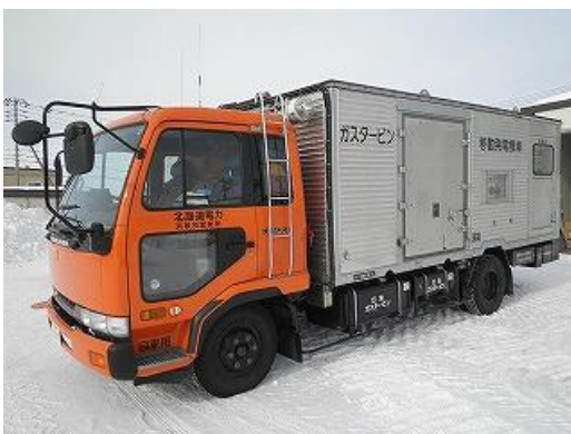
▲ ガスタービン高圧移動発電機車
