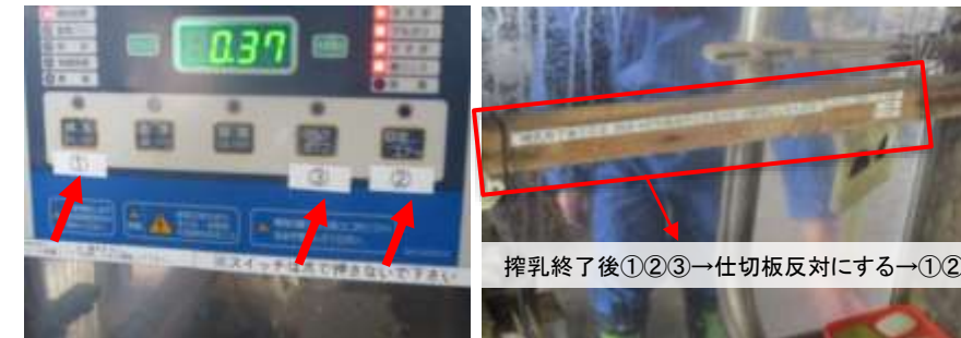
ミルク作動パネルに番号をつけて、操作手順をテプラで表示。
