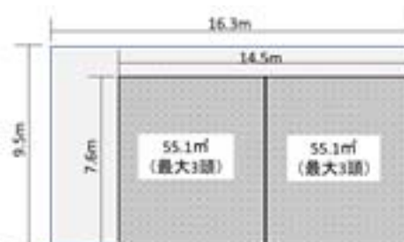
図4 乾乳牛舎内部の広さ
