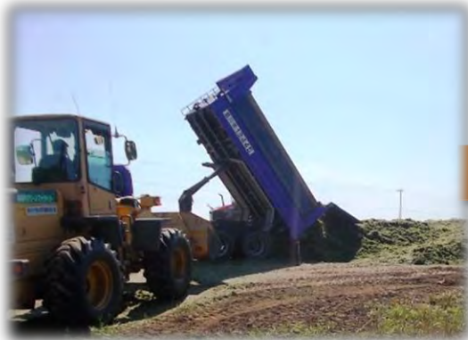
① ダンプから荷下ろし ショベルは敷いた草の上に待機
