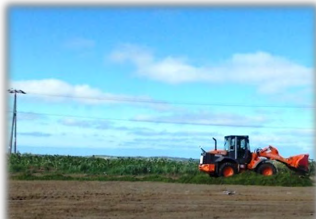
⑥ 前後・斜めに移動を繰り返し、元の厚さ(30cm程度)の半分の厚さになるまで踏む
