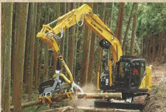
ハーベスタ：立木の伐倒・材の枝払い・玉切りまでの一連の工程を1台で行う機械。
