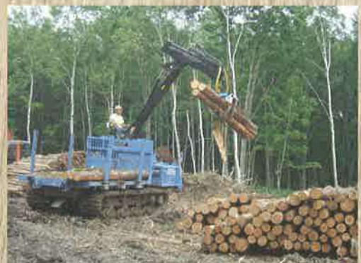
フォワーダ：材を載荷して、現場内の小運搬をする車両。
