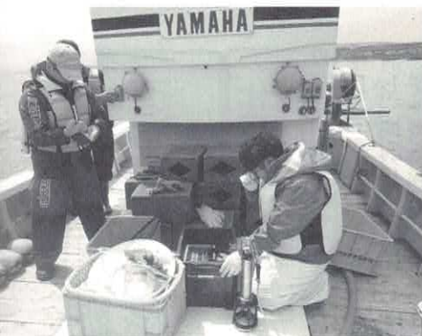
(左) 水温・塩分濃度・栄養分を測定します (右) 観測機器を引き揚げ中
